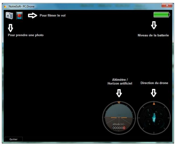
Le drone est équipé de 2 caméras. Une dans le nez, l'autre dessous le fuselage. Cette image est une capture de l'écran de notre PC avec le drone en vol stationnaire devant nous. Voici ce qu'il voit avec la caméra intégrée dans le nez du drone.
